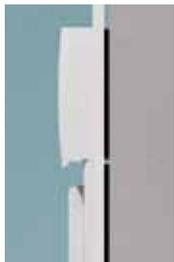
À l'intérieur, le bord du coffre est aligné avec l'ouvrant de la menuiserie.
